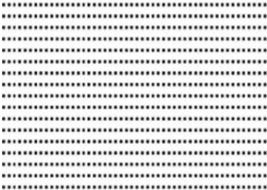
Отверстие сопла в норме
