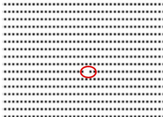
Одно из отверстий сопла не работает
