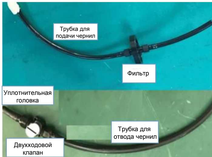
Рис. 4-2. Инструкция по использованию чернильной трубки
