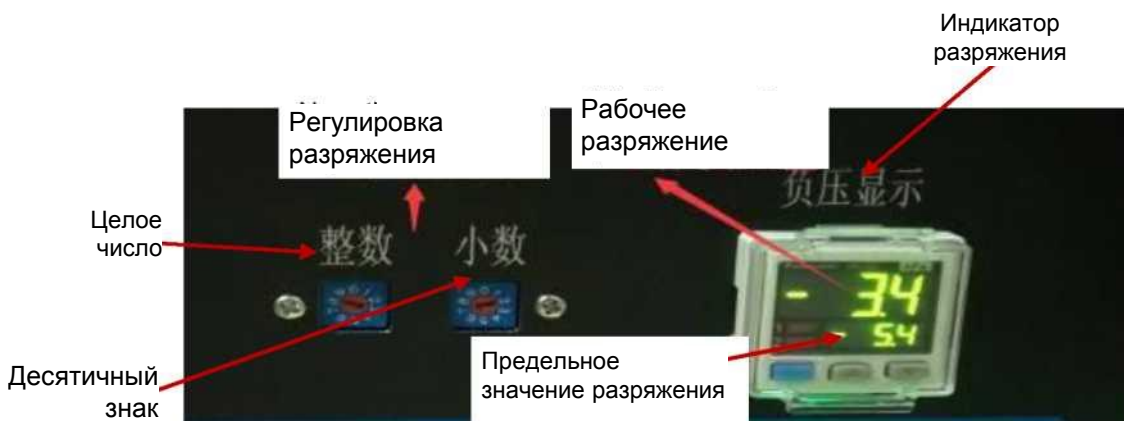
Рис. 8-1 Схема индикации параметров разряжения
