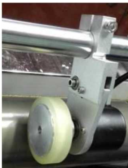
Рис. 4-5. Схема установки синхронизатора
