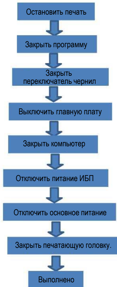
Рис. 14-2. Блок схема порядка отключения питания системы
